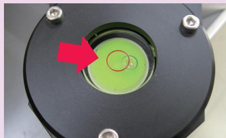
2 気泡がずれている方向に電柱を傾けて傾斜を調整
