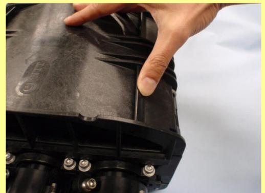
③冶具を抜き、バックルを手で押し込みます。
