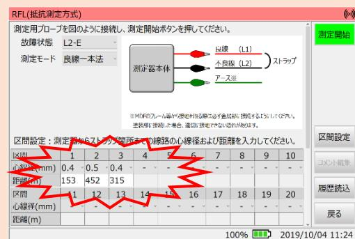
② 「区間長の演算と心線径の選択、およびデータ入力」の自動化
